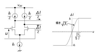
図6 差動対の伝達特性(入力電圧と出力電流)
