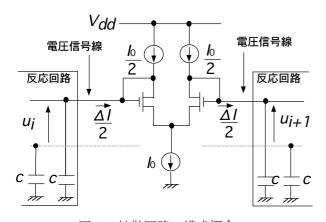
図8 拡散回路の構成概念
