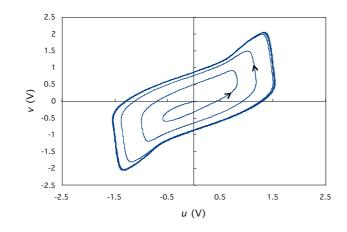
a:b:c:d = 3:3:3:2, C = 10 pF,  $I_0 = 50$ 口 $\iota$  A,  $V_{dd} = 5$  V 図 1 2 回路の電源制限によるリミットサイクル
