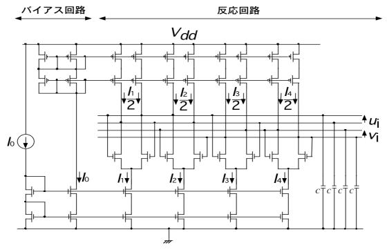
図7 CMOS反応回路
