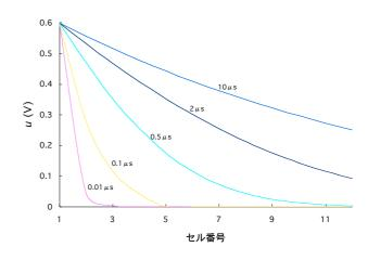
図14 拡散回路の動作
