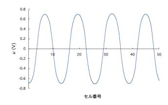
a:b:c:d=1:1.2:1:1.1,口 $_0=50$ 口 $\iota$  A,口 $_0=10$ 口下口 $_u:D_v=1:10$ 図 1 7 (b) チューリングパターンの発生(その 2)
