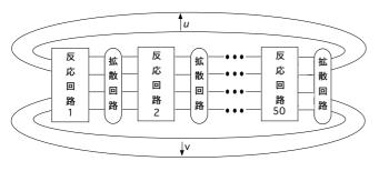
図15 一次元の反応拡散回路
