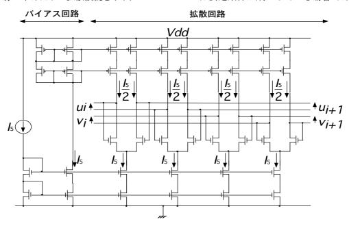
図9 CMOS拡散回路
