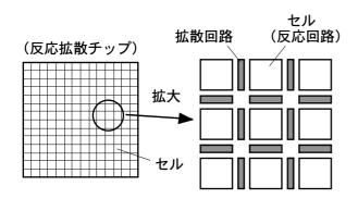
図3 反応拡散チップの構成
