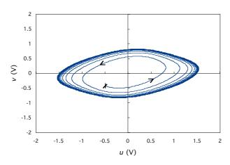
a:b:c:d = 3:7:3:2, C = 10 pF,  $I_0 = 50$ 口 $\iota$  A,  $V_{dd} = 5$  V 図 1 1 反応回路の動作(リミットサイクル)
