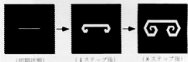
図 14 セルオートマトン反応回路の動作例
