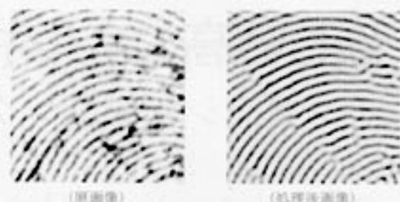
図17 Wilson-Cowan反応拡散チップを用いた指紋画像復元
